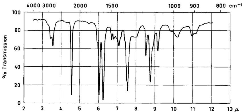
Fig. 1. IR.-Spektrum von 1-Methyl-3-cyan-1,6-dihydro-pyridin (II a) in  $\text{CH}_2\text{Cl}_2$
