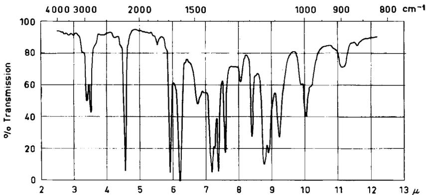
Fig. 2. IR.-Spektrum von 1-Methyl-3-cyan-1,4-dihydro-pyridin (II b) in  $\text{CH}_2\text{Cl}_2$
